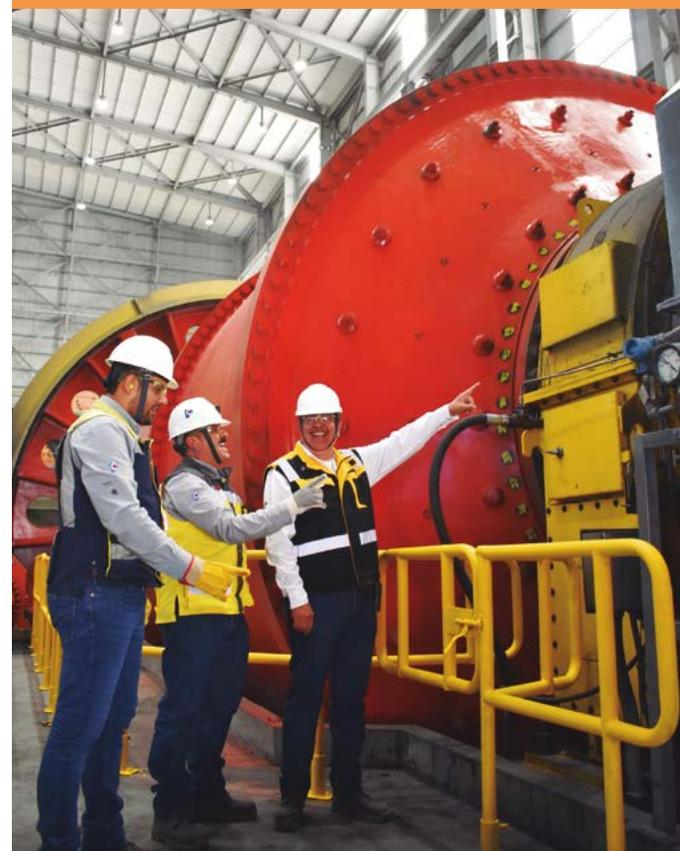
La función del molino de bolas es fundamental en nuestras operaciones, ya que sirve para darle el tamaño ideal al concentrado de mineral de hierro, y se pueda realizar el boleo en la peletizadora, de tal forma que permita eliminar la ganga (material estéril; colas) en concentración magnética, y con esto cumplir la especificación de calidad comprometida con nuestro cliente.
